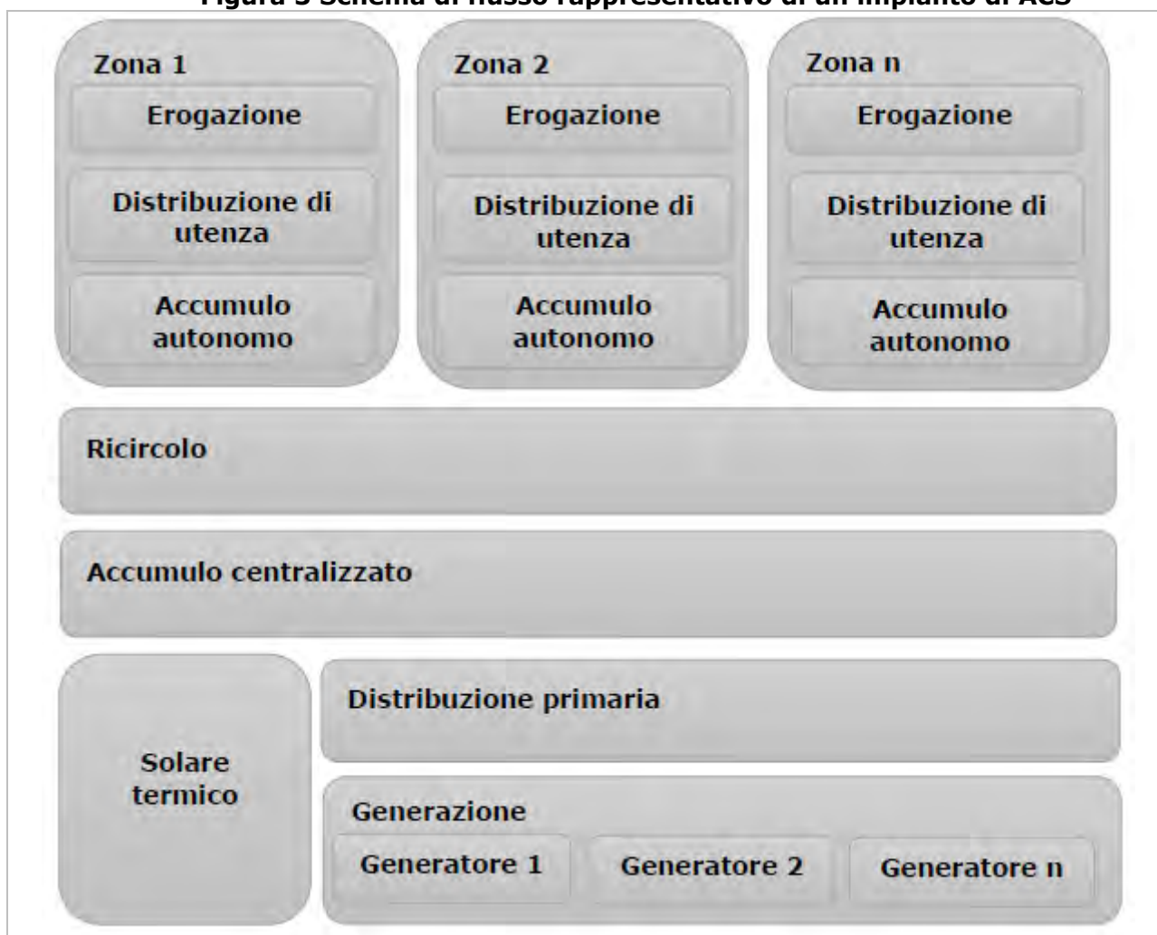
Figura 3 Schema di flusso rappresentativo di un impianto di ACS
