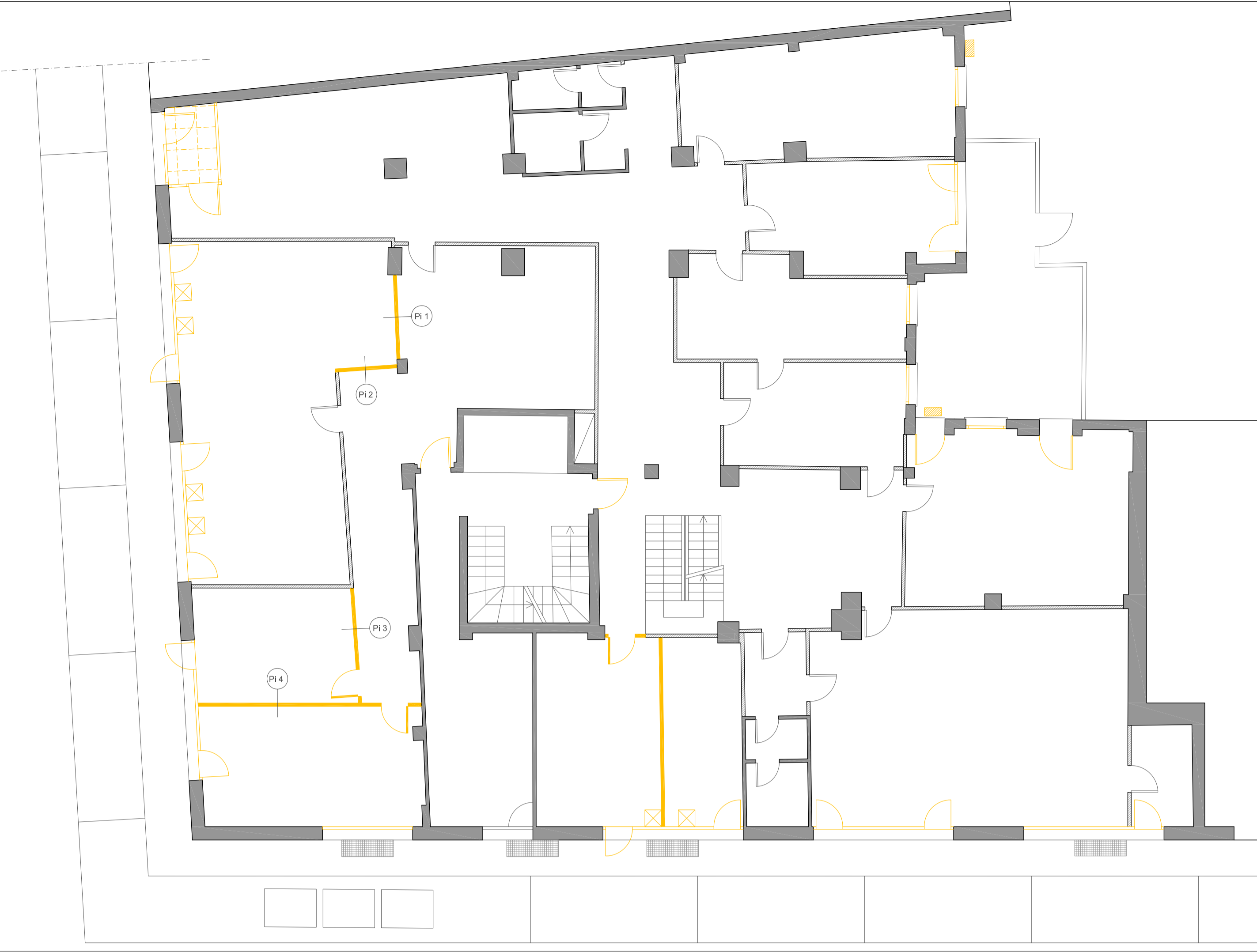
DEMOLIZIONI PIANTA PIANO TERRA
