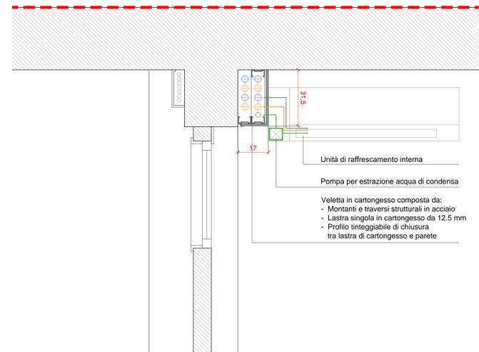
Dettaglio n.1. VELETTA IN CARTONGESSO PER IMPIANTISTICA A/C, scala 1:10
